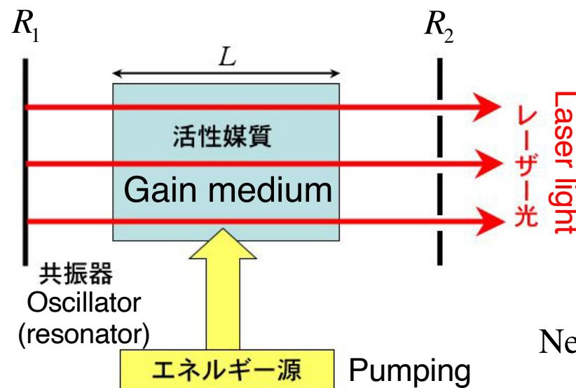
Lasing condition 定常的なレーザー発振の条件
